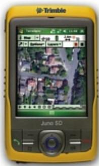
Универсальное полевое устройство для управления объектами, с сотовым модулем 3.5G для голосовой связи и передачи данных. Контроллер Juno® SD - это надежный и легкий полевой компьютер, объединяющий в себе ряд мощных функций. Благодаря наличию функции захвата фотоизображений, встроенного модуля сотовой связи для передачи данных и речевых сигналов, а также мощного модуля GPS-позиционирования, контроллер Juno SD расширит возможности и повысит производительность всех ваших выездных бригад.
