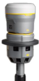
Наземный переносной фотограмметрический комплекс Trimble V10 позволяет получать геопространственные данные с высокой точностью позиционирования и цифровые панорамы с углом обзора 360° для последующих обмеров в камеральных условиях и для визуальной документации. Trimble V10 отлично подходит для специалистов, выполняющих работы в различных отраслях промышленности (в том числе съемка, ГИС, машиностроение, нефтяная и газовая отрасли).
