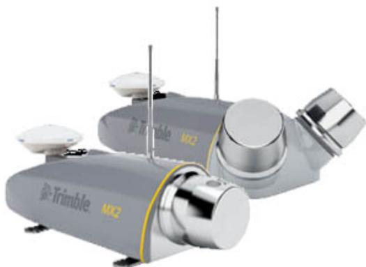
Trimble MX2 - это мобильная лазерная сканирующая система, которая устанавливается на транспортных средствах и объединяет в себе лазерное сканирование высокого разрешения и точное позиционирование для захвата облаков точек с использованием геопривязки.
