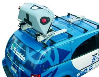
Trimble MX8 объединяет в себе лазерное сканирование премиум-класса и технологию позиционирования и съемки для получения привязанных облаков точек и снимков высокого разрешения. Заключенный в прочный корпус и полностью откалиброванный MX8 способен осуществлять сканирование более одного миллиона точек в секунду, что позволяет воспроизводить имеющуюся инфраструктуру с высоким качеством, а также осуществлять ее моделирование.
