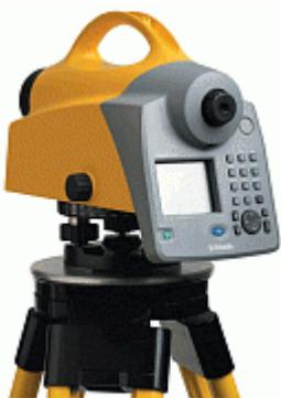
Цифровой нивелир Trimble DINI 03 или 07 позволяет осуществлять нивелирные измерения с удивительной простотой, при этом измерения осуществляются с отличной производительностью, а скорость съемки всего 3 секунды на измерение. Данный нивелир Trimble DINI подходит как для простого нивелирования, так и для высокоточного мониторинга и слежения за различными деформациями. Все полученные данные автоматически записываются и надежно хранятся в внутренней памяти нивелира Trimble DINI.
